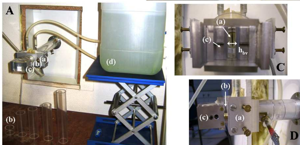
FIG. 4.8 – Photographies de la maquette déformable auto-oscillante de cordes vocales couplée à la maquette rigide statique de bandes ventriculaires. A : vue d'ensemble du dispositif; B : vue de dessus; C : vue de face; D : vue de profil.
