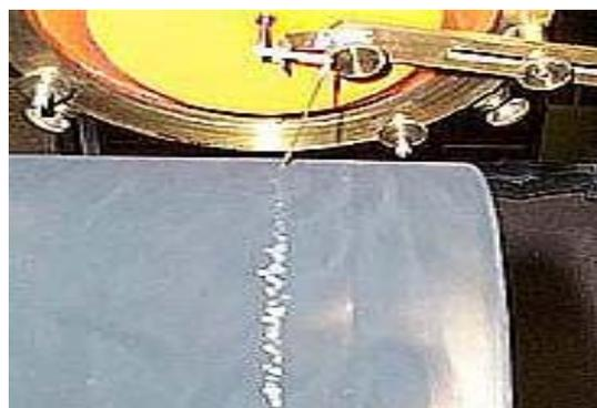
Figure 2 : Membrane, aiguille, tambour et trace d'un signal du *Phonautographe* de Scott.
