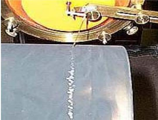
**Figure 2 :** Membrane, aiguille, tambour et trace d'un signal du *Phonautographe* de Scott (collection particulière).
