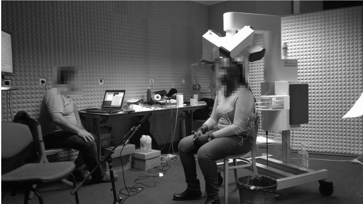
Figure 15: Le dispositif EMA (LORIA, Nancy) utilisé pour l'acquisition de données articulatoires dans le cadre de cette étude.
