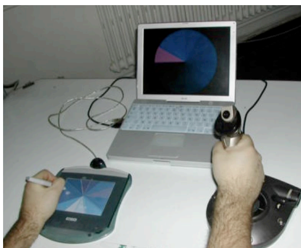
FIGURE 1.11 – Configuration « Tablette + Joystick » du Voicer, d'après [Kes04]
