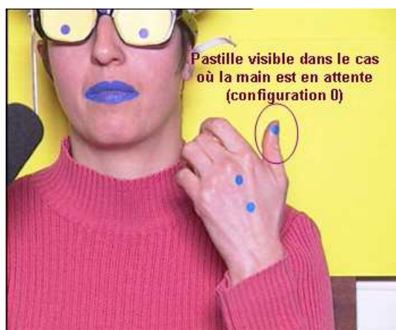
FIG. 6.14 – Cas où une pastille est visible (ici la pastille du pouce) alors qu’aucune configuration LPC n’est codée. L’image est prise à un instant M2 .
