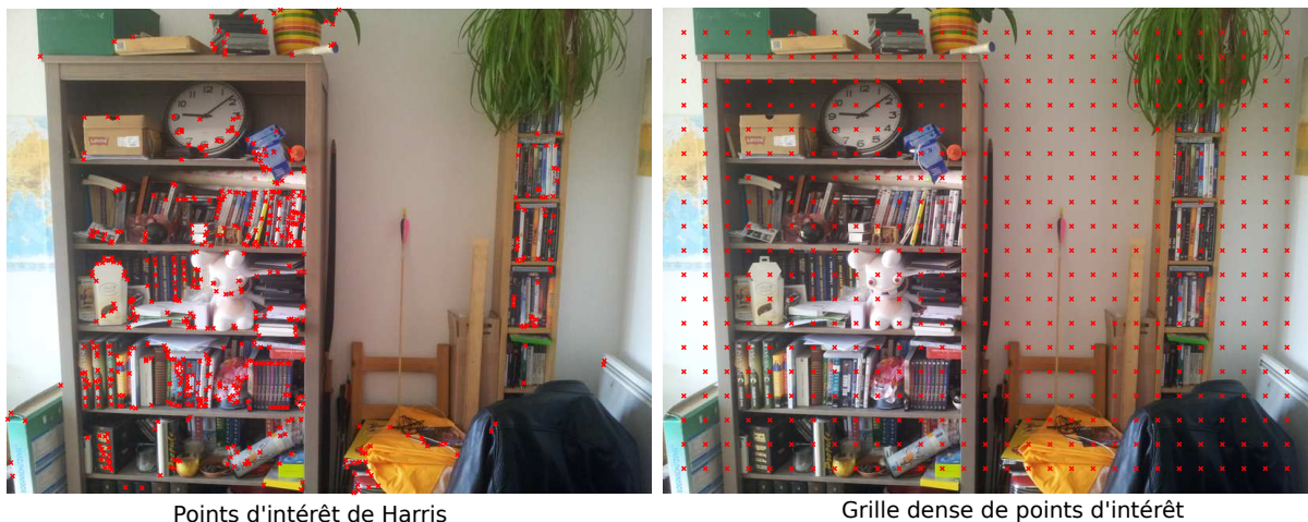
FIGURE 2.4 – Exemple de points d'intérêt extraits avec un détecteur de Harris et à partir d'une grille dense de points d'intérêt.
