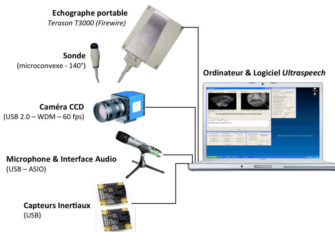
Figure 2.11 : Système d'acquisition multi-flux SA2 – Éléments matériels
